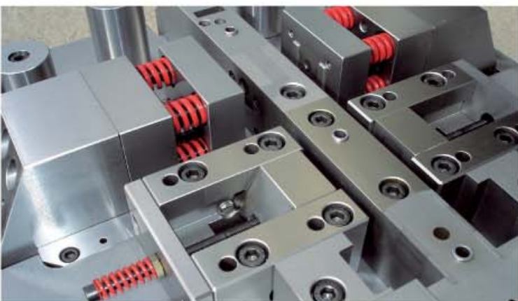
Folgeverbundwerkzeug für Magnetbügel (Elektroindustrie)
